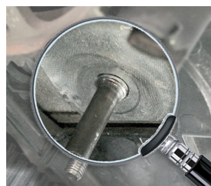
Figur 1: Skruen er ikke skrudd inn riktig
