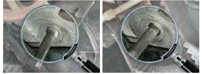
Şekil 1: Saplama doğru şekilde takılmamış. Şekil 2: Saplama doğru şekilde takılmış.
