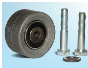
Снимка 1: Предишната конструкция е изработена от метал
