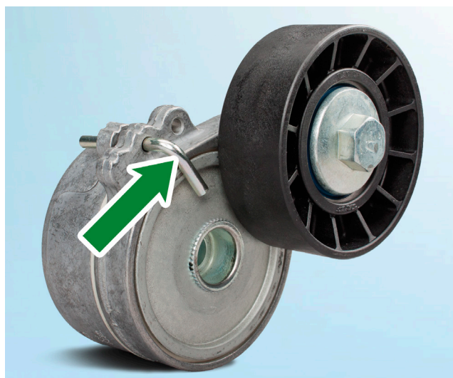
Obrázek 1: 534 0110 20 – INA-napínací jednotka s pojistným kolíkem
