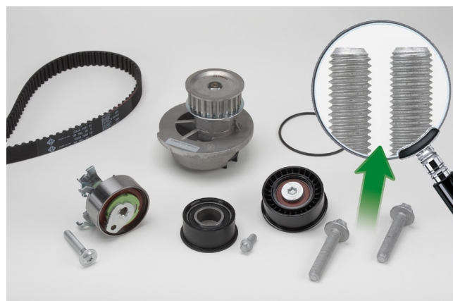
Figur 1: Eksempel på INA vannpumpesettet 530 0443 30 med begge typer veivakselkruer
