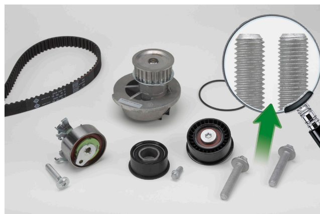
Figura 1: Exemplificare a KIT-ului INA pompă de apă 530 0443 30 cu ambele tipuri de șurub pentru arborele cotit
