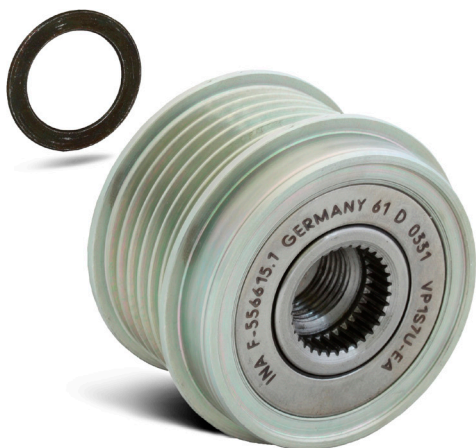
Снимка 2: При монтажа на механизъм за свободен ход на генератор на генератор Bosch трябва да се използва приложеният дистанционен елемент с дебелина от 1,4 мм!
