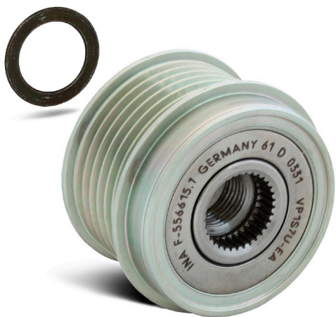
Εικόνα 2: Κατά την τοποθέτηση της τροχαλίας δυναμό με κασάνια σε ένα δυναμό Bosch, πρέπει να χρησιμοποιείται ένας αποστάτης με πλάτος 1.4 mm!
