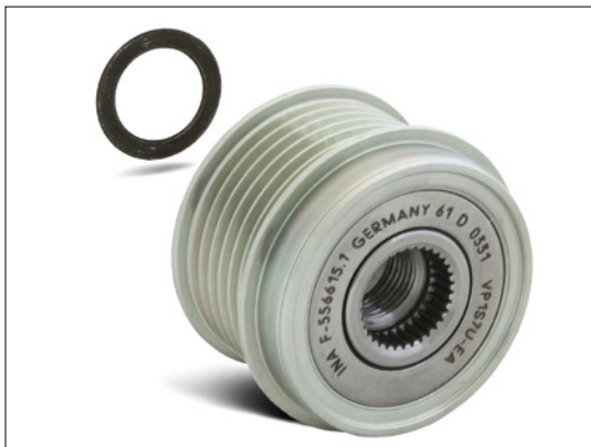
Figura 2: Para el montaje de la polea libre en un alternador Bosch, se debe utilizar el disco distanciador de 1,4 mm de grosor.
