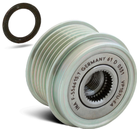
2. ábra: A generátor szabadonfutónak egy Visteon generátorra (Ford Mondeo III) történő beszerelésékor a mellékelt 3 mm vastag távtartót kell használni!
