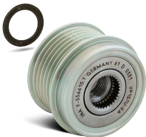
Figur 2: Ved montering av friløpsremskiven OAP på en Bosch generator, må den medfølgende 1,4 mm tykke skiven brukes!
