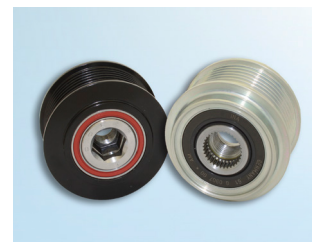
Рисунок 2: Шкив генератора с обгонной муфтой 535 0229 10
