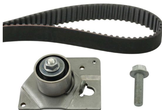
1. ábra: 530 0196 10 - INA javító KIT a vezérlésmeghajtásokhoz az 536 0278 10 cikkszámú fogasszíjjal, 533 0087 20 cikkszámú feszítőgörgővel és forgattyústengely csavarral
