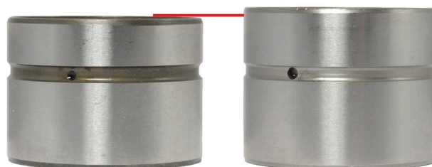
Billede 1: Hydraulisk ventilløfter: til højre: gammel version, højre: ny version
