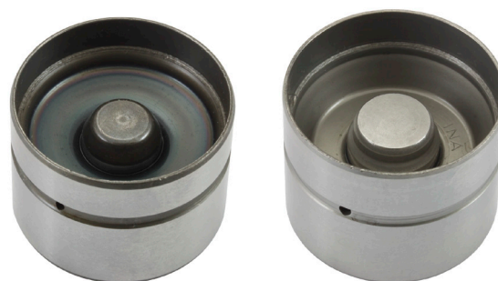
Billede 2: Hydraulisk ventilløfter, venstre: gammel version, højre: ny version
