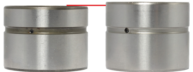
Kuva 1: kuppimaiset hydrauliset venttiilinnostimet, vasemmalla vanha malli, oikealla uusi malli
