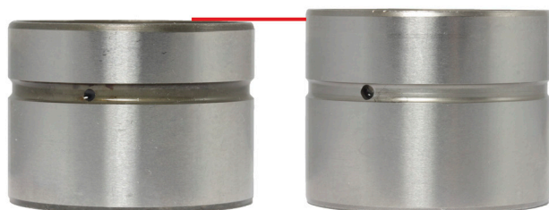
1. ábra: Hidraulikus szelepemelő tőke, balra - régi kivitel/jobbra - új kivitel
