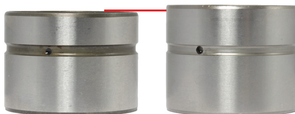
Figur 1: Hydraulisk ventilløfter: venstre: tidligere versjon, høyre: ny versjon
