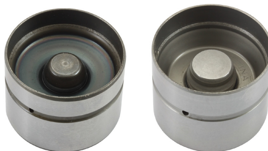
Figur 2: Hydraulisk ventilløfter, venstre: tidligere versjon, høyre: ny versjon
