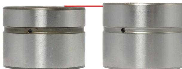
Рисунок 1: Гидрокомпенсатор: слева: прежняя версия, справа: новая версия
