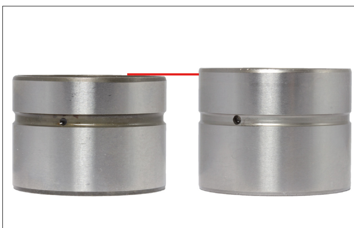
Obrázok 1: hydraulická misková zdvíhátka, vľavo je staré vyhotovenie, vpravo nové vyhotovenie
