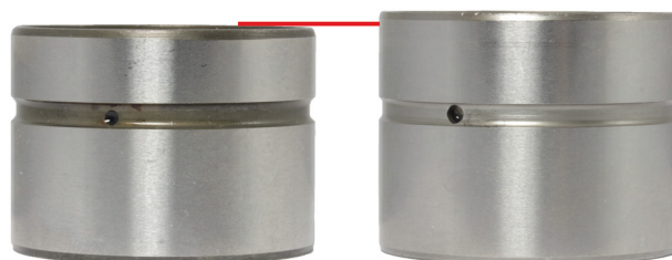
Bild 1: hydrauliska tallrikslyftare, till vänster det gamla utförandet, till höger det nya utförandet
