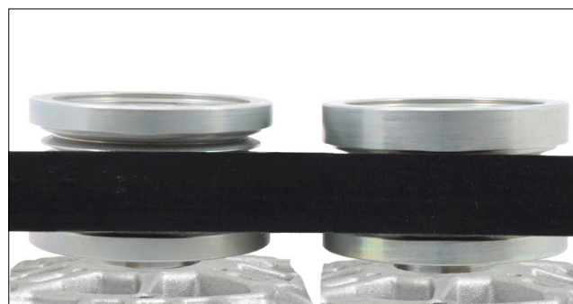
Obrázek 1: Vlevo, alternátorová volnoběžka INA 535 0202 10 s 6 drážkami – vpravo, alternátorová volnoběžka s 5 drážkami
