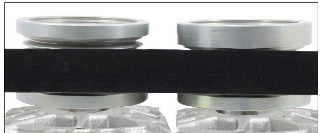
Εικόνα 1: Αριστερά, τροχαλία δυναμό με καστάνια INA 535 0202 10 με 6 αυλάκια – Δεξιά, τροχαλία δυναμό με καστάνια με 5 αυλάκια
