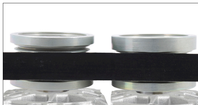
Рисунок 1: Слева шкив генератора INA с обгонной муфтой с 6 канавками, артикульный номер 535 0202 10 – справа шкив генератора с обгонной муфтой с 5 канавками
