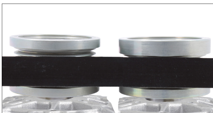
Slika 1: Levo: jermenica alternatorja s sklopko za prosti tek 535 0202 10 s 6 utori po obodu blagovne znamke INA – desno: jermenica alternatorja s sklopko za prosti tek s 5 utori po obodu
