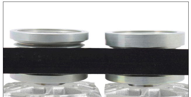
Зображення 1: Шків генератора з обгінною муфтою 535 0202 10 з 6 канавками (зліва), шків генератора з обгінною муфтою з 5 канавками (справа)
