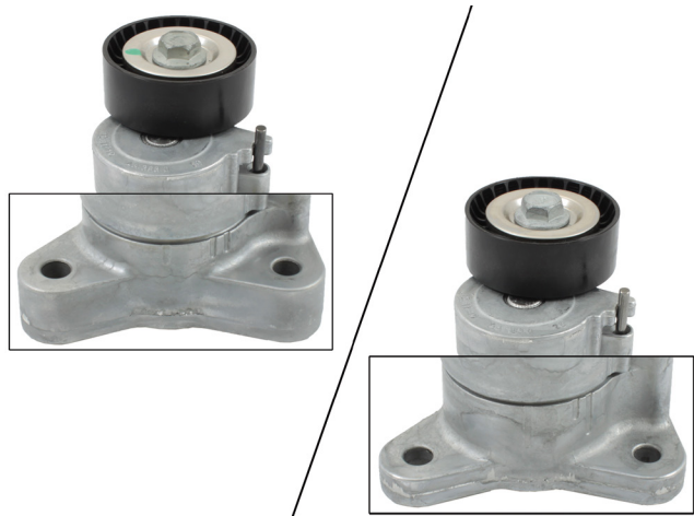
Kuva 3: Vasemmalla, vanha malli korkeammilla kiinnityspisteillä. Oikealla, uusi malli matalammilla kiinnityspisteillä.
