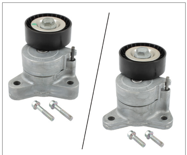
Figura 1: braccio tenditore 534 0325 10 – a sinistra, versione precedente con viti di fissaggio. A destra, versione modificata con viti di fissaggio.
