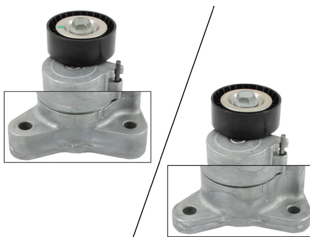
Figura 3: Stânga, vechea versiune, cu elemente de fixare late. Dreapta, noua versiune, cu elemente de fixare înguste.
