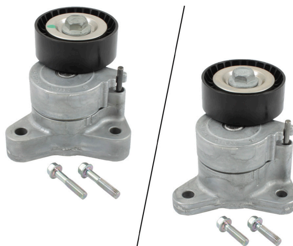
Рисунок 1: Натяжная планка 534 0325 10 Слева, старое исполнение с крепежными винтами M8x40, справа, новое исполнение с крепежными винтами M8x30.
