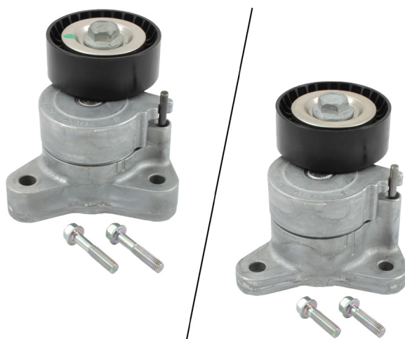
Bild 1: Spännarm 534 0325 10 - vänster tidigare utförande med fästskruvar. Höger, nytt utförande med fästskruvar
