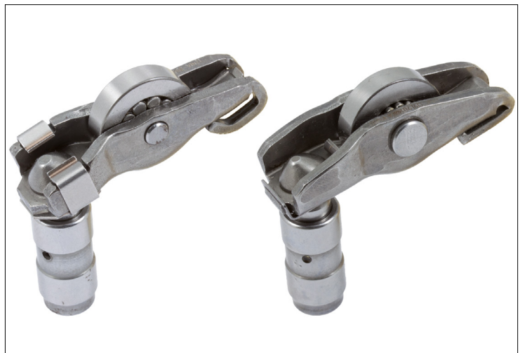
Obrázok 1: 423 0079 10 – vľavo je staré vyhotovenie, vpravo nové vyhotovenie
