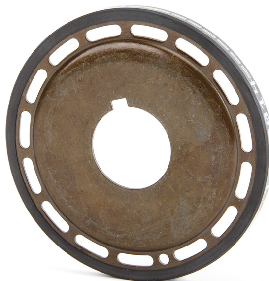
Slika 1: 544 0095 10 – davač impulsa sustava za upravljanje radom motora.
