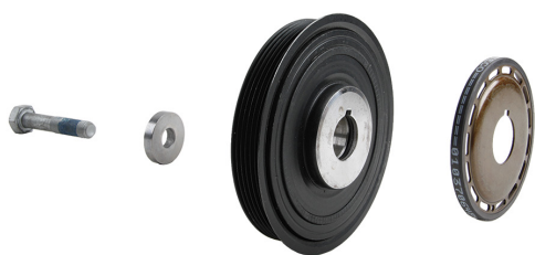
Slika 2: Davač impulsa i remenica ublaživača vibracija koljenastog vratila.
