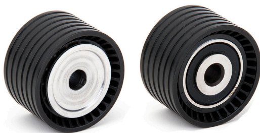
Рисунок 1: Обводной шкив со старой конструкцией уплотнения
