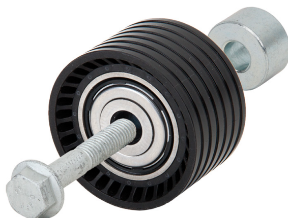
Bild 2: 532 0654 10 - brytrulle med nytt tätningskoncept och monteringsdetaljer
