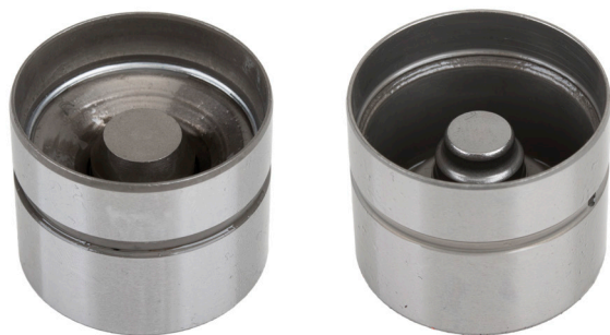
Ábra: Balra - a konkurencia hidraulikus szelepemelő tőkéje, jobbra - INA hidraulikus szelepemelő tőkéje (cikksz. 420 0059 10)
