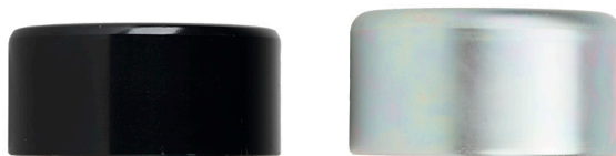
Снимка 3: Ляв- стар дизайн с 33 мм повърхност за движение; десен - нов дизайн с 37 мм повърхност за движение
