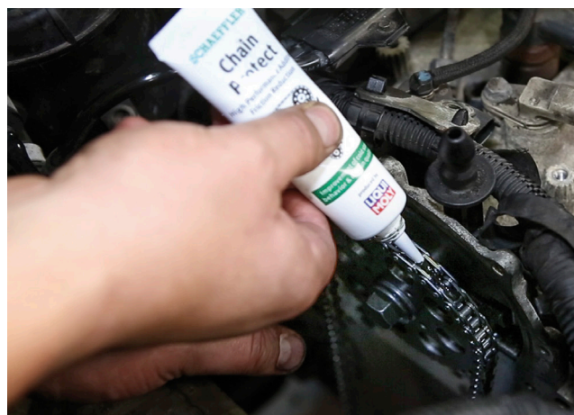
Obrázek 2: Aditivum Chain Protect od společnosti Schaeffler se nanese během montáže řetězu na všechny komponenty řetězového pohonu
