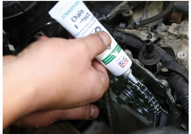
Kuva 2: Schaefflerin Chain Protect -lisäainetta levitetään ketjun asennuksen yhteydessä kaikkiin ketjukäytön komponentteihin
