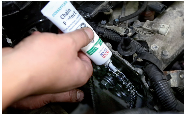
Figura 2: Schaeffler Chain Protect viene applicato durante il montaggio della catena su tutti i componenti della distribuzione.
