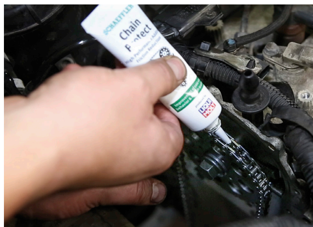
Рисунок 2: Schaeffler Chain Protect применима для всех цепных приводов и их компонентов во время установки
