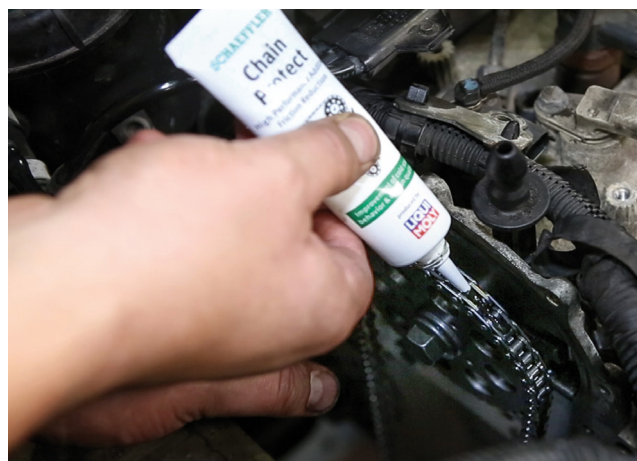
Bild 2: Tillsatsen Chain Protect från Schaeffler appliceras på alla komponenter i kedjedrivningen vid montering
