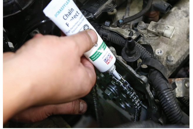
Resim 2: Schaeffler Chain Protect, zincir takılması sırasında tüm zamanlama zinciri sistemleri bileşenlerine uygulanabilir
