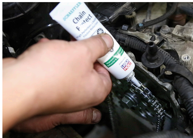
Зображення 2: Schaeffler Chain Protect наноситься на всі компоненти привода ГРМ під час монтажу ланцюга.
