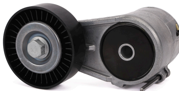
Slika 1: Primjer natezne remenice sa zatikom za blokadu položaja
