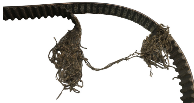
Снимка 1: Разхлабен зъбен ремък
