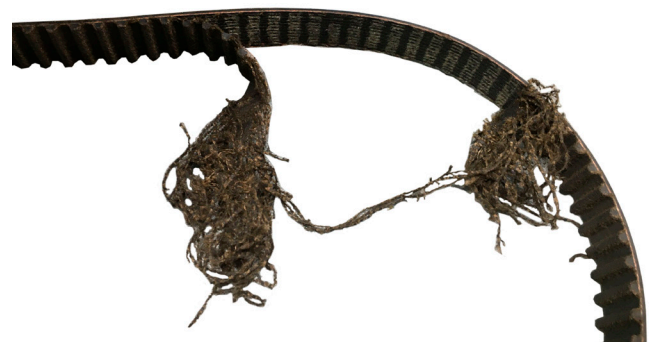
Fig. 1: Correa dentada con desprendimiento de tejido dentado
