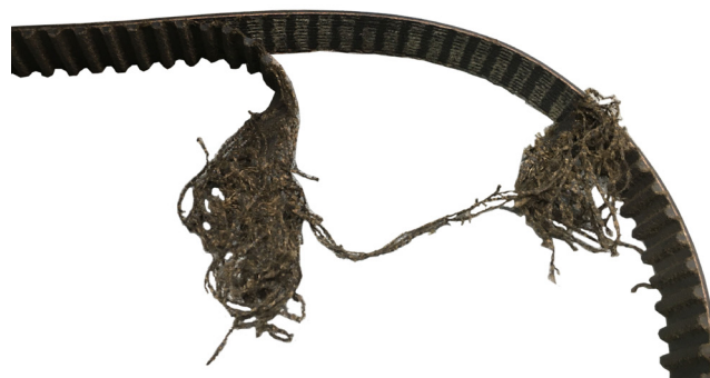
Fig. 1: Correia dentada danificada com desprendimento do tecido dentado
