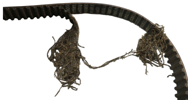
Fig. 1: Curea dințată cu angrenarea dinților slăbiți
