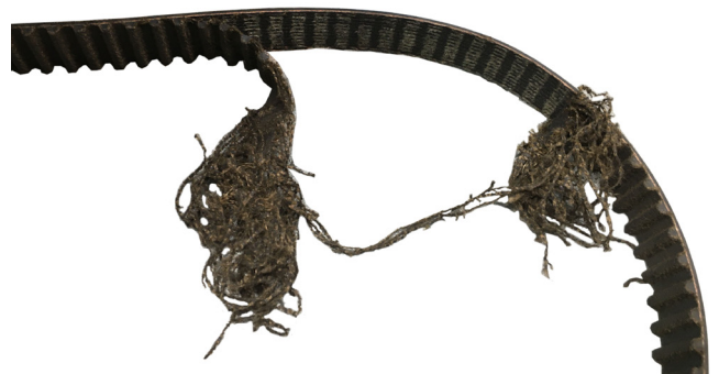
Зображення 1: зубчастий ремень з відшарованими зубцями
