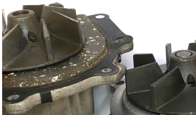
Снимка 1: Изместено работно колело с точкуване (вляво); правилно положение на работното колело (вдясно)
